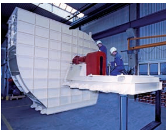
Промышленный вентилятор в стадии изготовления
