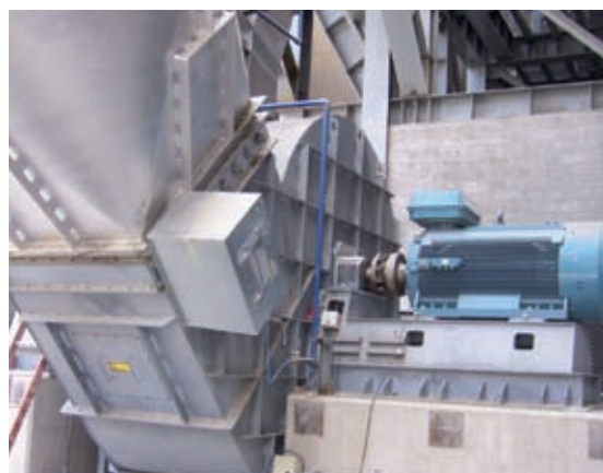
Промышленный вентилятор с подшипниками с обеих сторон
