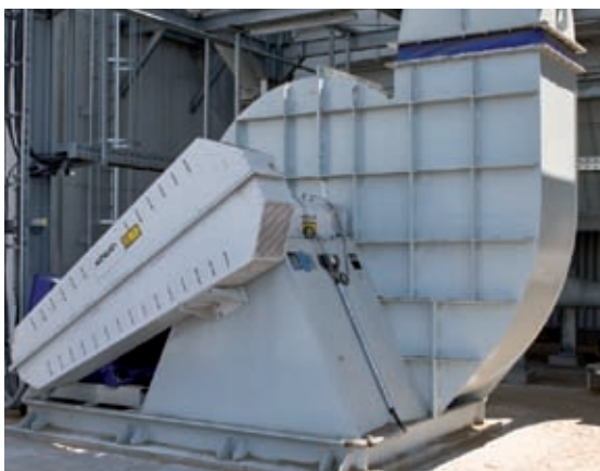
Транспортный вентилятор с ремённым приводом
