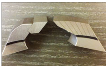
Сравнение зуба фрезы с напаянными ножами (слева) и цельной фрезой
