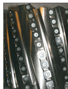
Фрезы Kvarnstrands: профильная (слева) и фреза Castor с поворотными ножами
