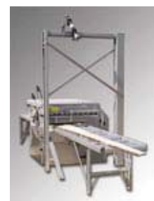
Высокоскоростные двухсторонние кромообрезные станки модели KME2
