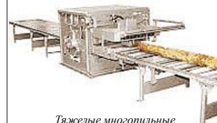
Тяжелые многотильные станки серий VM (макс. толщина пиломатериала 160 мм) и S (макс. толщина 225 мм)
