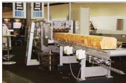
Многопильный станок PAUL S 900 (высота распила 225 мм)
