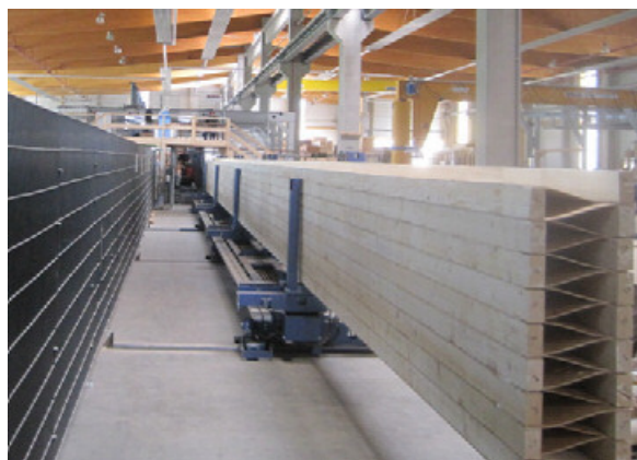
Разгрузка обработанного элемента KIELSTEG за прессом
